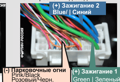
4 Back of fuse box Сзади блока предохранителей White connector Back View Белый разъем вид сзади
