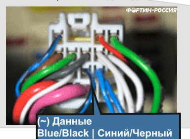
3 Left of fuse box Слева от блока предохранителей White connector Back View Белый разъем вид сзади
